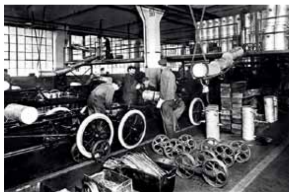
Masseproduksjon T-Forden ble produsert i over 15 millioner eksemplarer i perioden 1908–27, og på det meste var annenhver bil i verden en Ford. Samlebåndet gjorde at det til slutt bare tok 93 minutter å sette sammen en bil. Bildet er fra fabrikken Highland Park i Michigan i 1913. Foto: FORD MOTOR COMPANY
